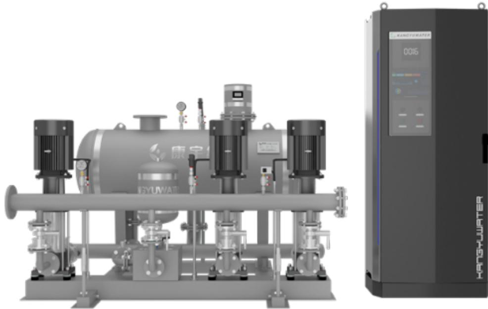
无负压供水设备是一种加压供水机组，直接与市政供水管网联接、在市政管网剩下压力基础上串联叠压供水而确保市政管网压力不小于设定维护压力（设定压力有必要高于小区直供区压力需求，一般不低于1.2Kg/cm<sup>2</sup>的二次加压供水设备。管网叠压(无负压)供水设备的中心是在二次加压供水系统运转过程中怎么避免负压发生，消除机组运转对市政管网的影响，在确保不影响邻近用户用水的前提下完成安全、牢靠、平稳、供水。无负压供水设备又被称之为管网叠压供水设备，市场上主要有罐式无负压供水设备与箱式无负压供水设备。
